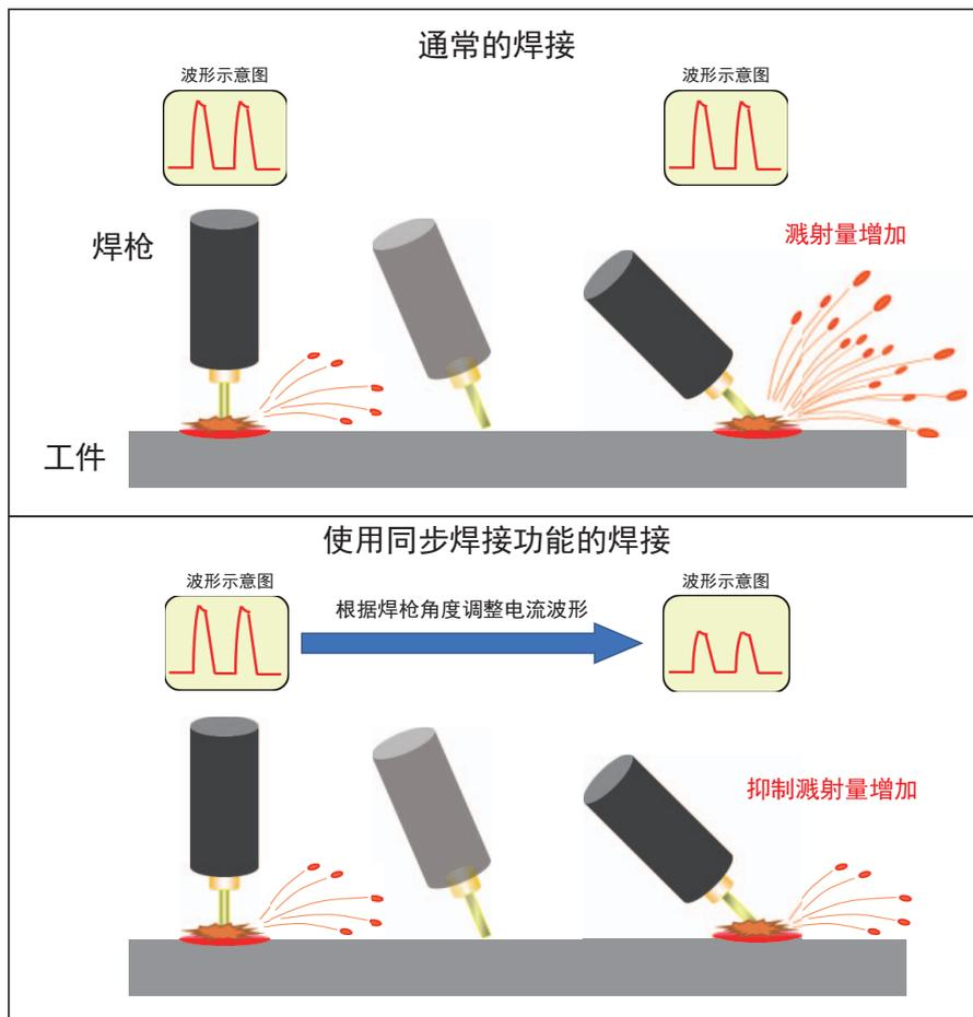
5 同步焊接功能 (适用焊机: MOTOWELD-X350)
